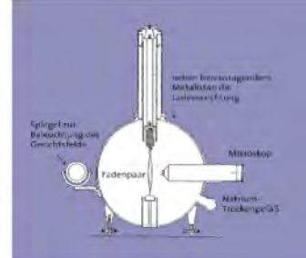
Schematische zeitgenössische Darstellung des Zweifadenelektrometers
