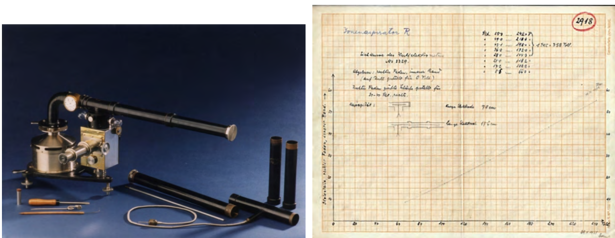
Abbildung 46: Ionenaspirator R (Aspirationsrohr rechts vom Elektrometer) mit allen Zusatz- und Ersatzteilen aus der Gerätesammlung des Physikalischen Instituts der Universität Graz im Bild 281 (links) und Datenblatt mit Eichkurve des Wulf-Elektrometers desselben 282 (rechts) aus dem Fundus von Adi Hohenester
